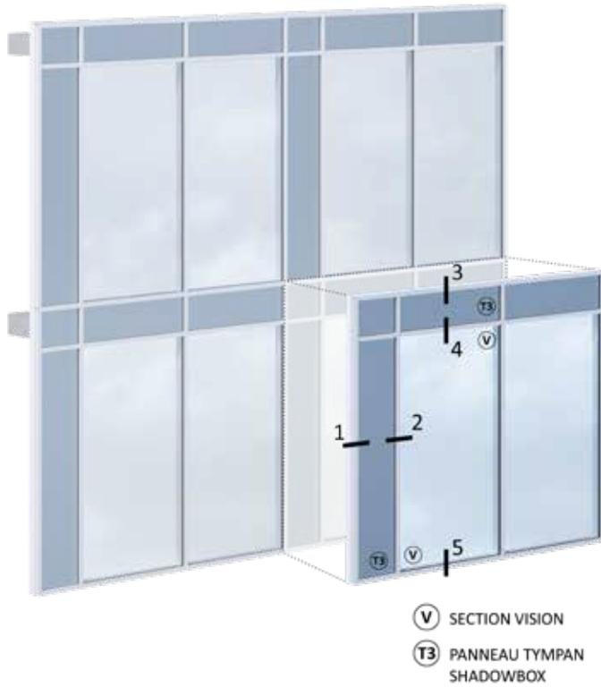
Les détails typiques illustrés sont formés par l'assemblage de différents types de meneaux et de couvercles. Voir la section "Éléments accessoires" pour d'autres choix de couvercles.
